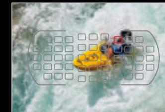
Modo de AF de área dinámica utilizando 51 puntos
